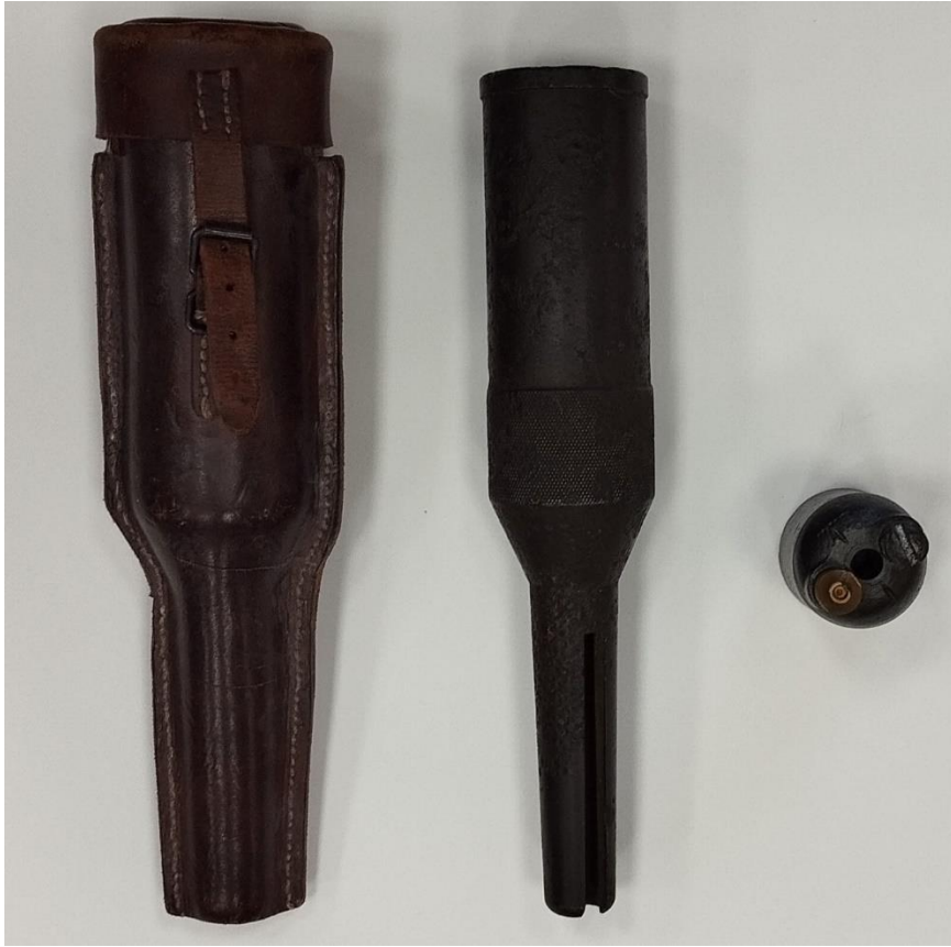
Le tromblon lance-grenade se fixe au bout du canon. Il permet en 1916 d'envoyer un projectile à 180m.
