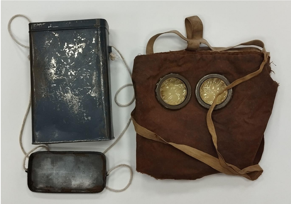
Le masque M2 rangé dans sa boîte métallique est équipé d'un pare-pluie.
